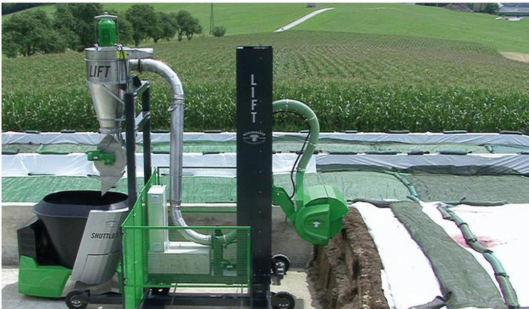
**Wasserbauer Shuttle Eco**, L: direkt Silo oder Entnahmeboxen, M: mobil vertikal, V: induktionsgelenkt fahrend, A: ja
